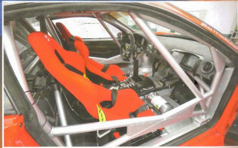
Der verstärkte Seitenaufprallschutz sorgt für die nötige Sicherheit
